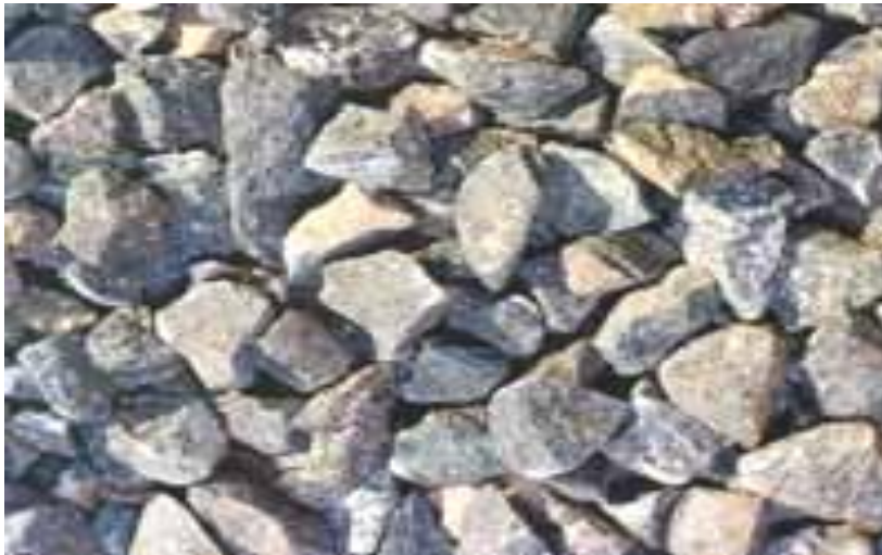
Рисунок 7. Искусственный щебень на основе опоки
