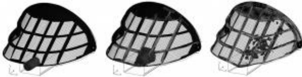
Рис.2 – Поэтапное конечно-элементное моделирование взрыва, *Dytran*
