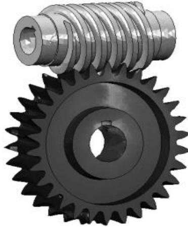
Рис.1 – Моделирование взаимодействия шестерен с учетом тепловых эффектов, *Marc*
