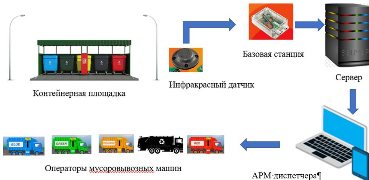
Рисунок 5 - Система дистанционного мониторинга наполнения мусорных баков для оптимизации процесса вывоза мусора
