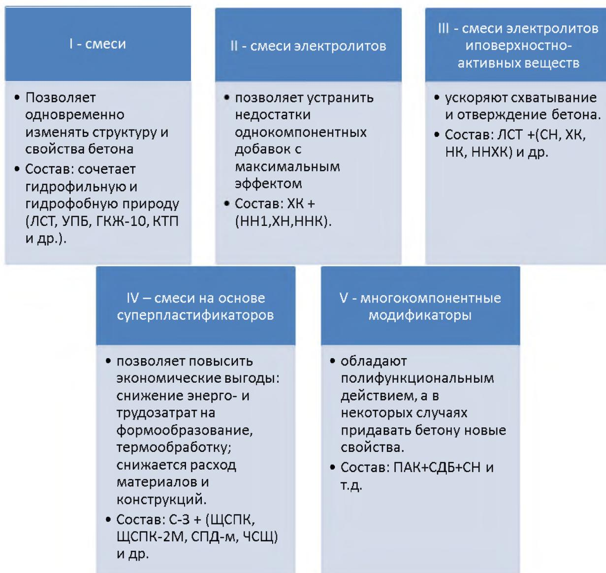
Рисунок 2 – Комплексные модификаторы бетонов
