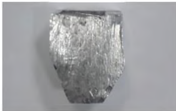
Рисунок 2. Заготовка после II циклов выдавливания в трехканальной матрице
