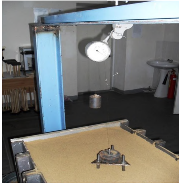
Рисунок 5 – Испытание модели 3- свайного куста
