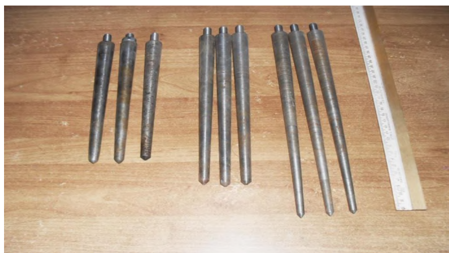
Рисунок 3 – Модели полуконических свай для испытаний с диаметром оголовка d=30 мм.
