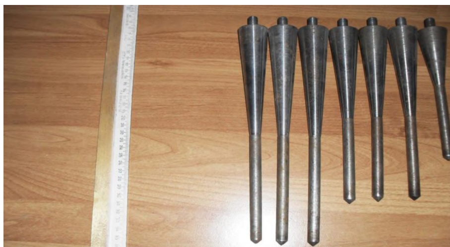
Рисунок 3 – Модели полуконических свай для испытаний с диаметром оголовка d=30 мм.
