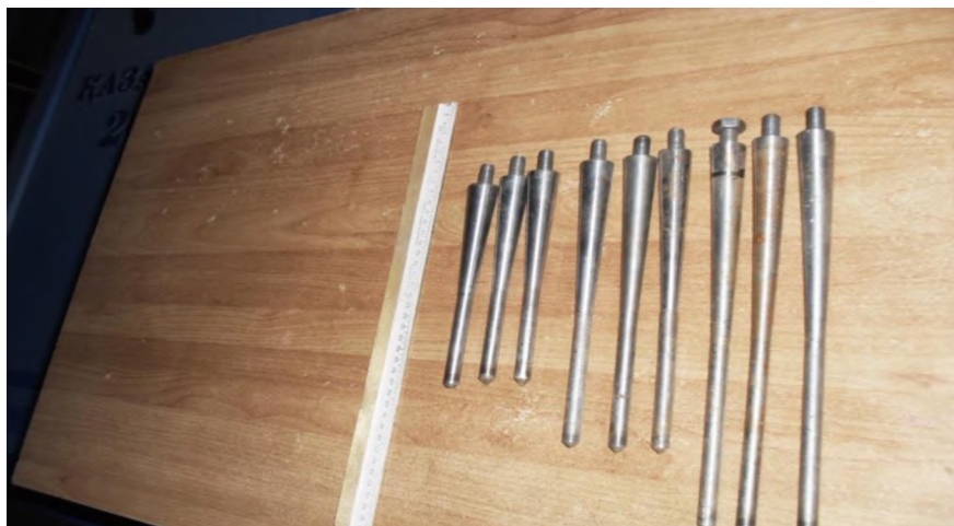
Рисунок 2 – Модели полуконических свай для испытаний с диаметром оголовка d=20 мм.
