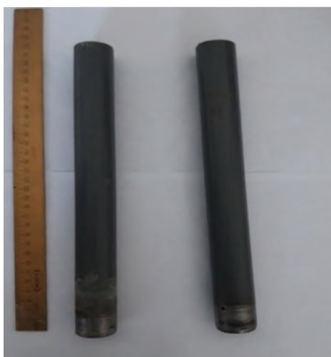
Рисунок 2. Модели классических буронабивных свайных фундаментов, применяемых в лабораторных исследованиях
