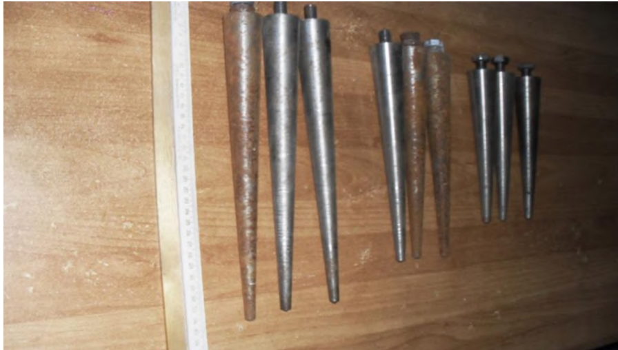
Рисунок 4 – Модели конических свай для испытаний с диаметром оголовка d=20 мм
