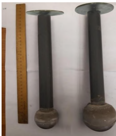
Рисунок 3. Модели камуфлетных свайных фундаментов применяемых в лабораторных исследованиях, перед испытаниями
