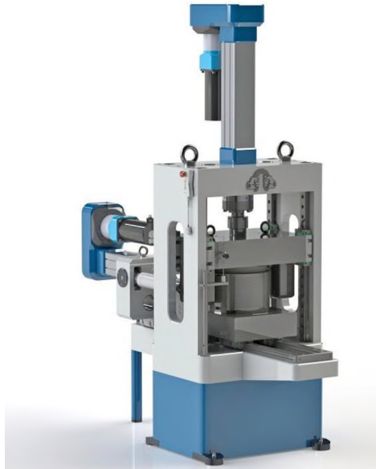
1 – сурет. Ірі түйіршікті топырақтарды сынақтауға арналған орын ауыстыру жабдығы
