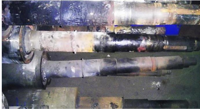
Рисунок 3. Следы выгорания смазки подшипников
