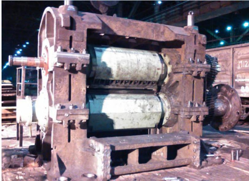
Рисунок 1. Барабанные летучие ножницы, установленные в НШСП-1700 АО «АрселорМиттал Темиртау»
