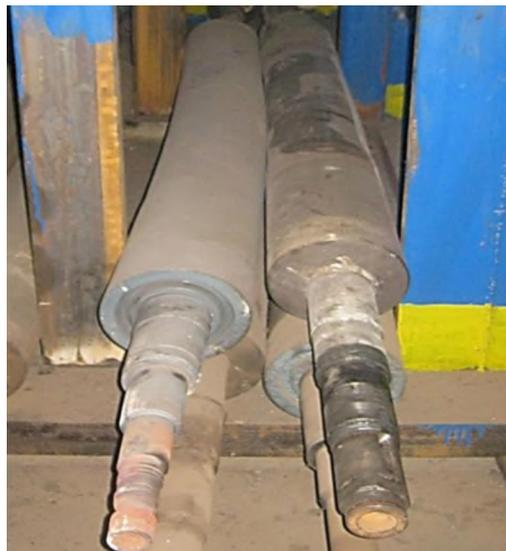
Рисунок 2. Деформация бочки и цапф роликов
