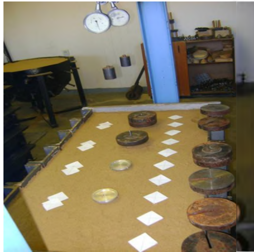
Рисунок 3. Испытания исследуемых фундаментов на объемном стенде
