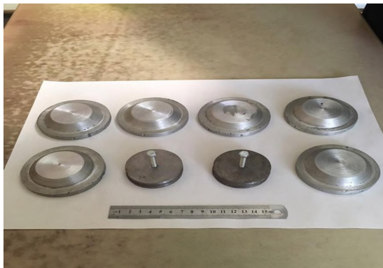
Рисунок 1. Модели исследуемых фундаментов с консольной пятой
