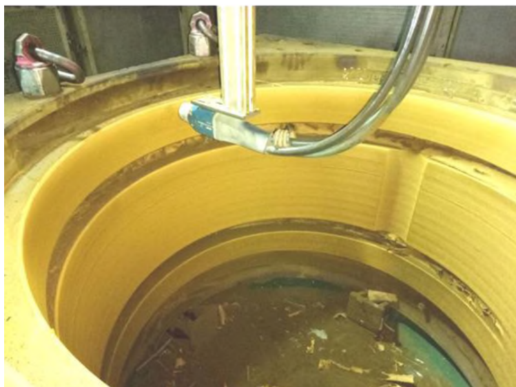
Рисунок 2. Металлизация внутреннего отверстия подушек прокатных валков
