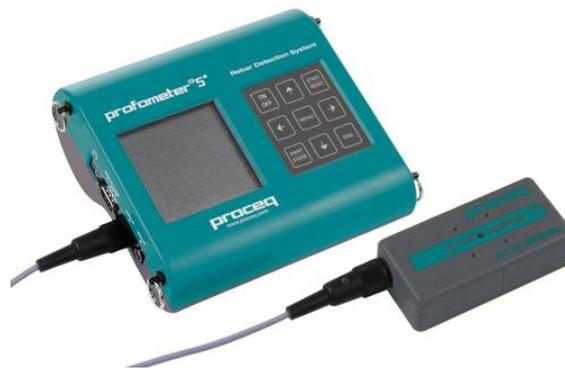
Рисунок 4. Система обнаружения арматурных стержней типа PROFOMETER
