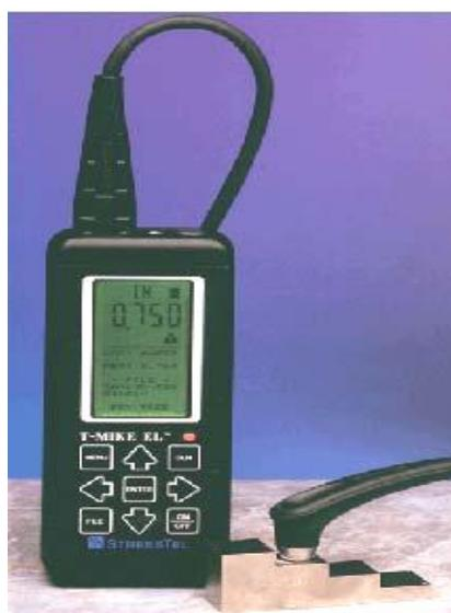
Рисунок 5. Общий вид ультразвукового толщиномера T-Mike EL
