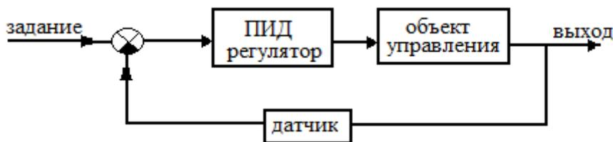
Рисунок 1. Схема управления на основе ПИД-регулятора
