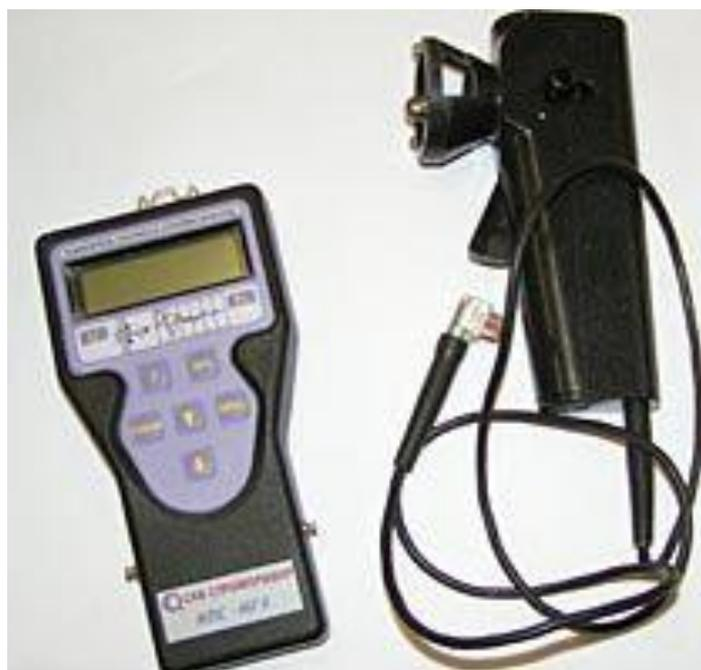
Рисунок 4. Общий вид склерометра электронного ИПС-МГ4
